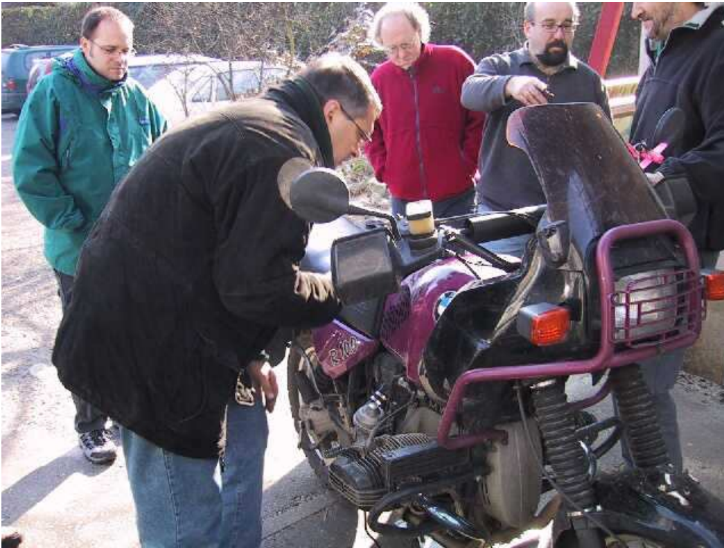
Experten-Team vom Freiburger-Schrauberkurs mit Versuchs Q beim Einstellen der Vergaser.
